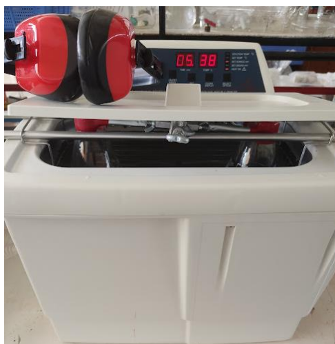
Figura 25. Baño ultrasónico y EPP empleados para extracción; Fuente: Propia
