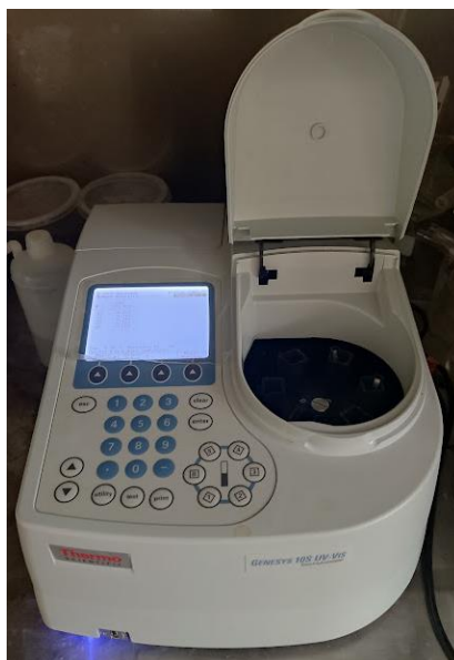
Figura 29. Espectrofotómetro utilizado en medición de absorbancia; Fuente: Propia
